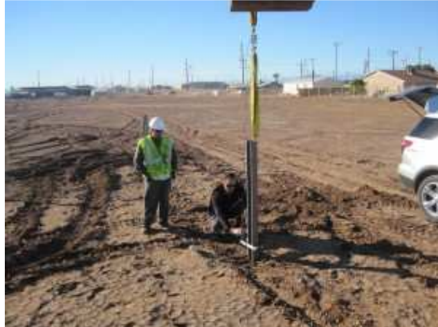
Imagen del Ensayo de Tracción.
